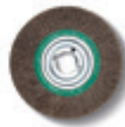
STAHLBÜRSTE Ø 250 mm x 60 mm, mit sehr hoher Drahtzugfestigkeit für besonders wirtschaftlichen Einsatz, Aufnahmebohrung Ø 51 mm. 0,2 mm Drahtstärke für dünnwandige Rohre und Profile. 0,35 mm Drahtstärke für universellen Einsatz. 0,5 mm Drahtstärke für dickwandige Rohre und Profile und hoher Entgratleistung. Edelstahl-Ausführung
